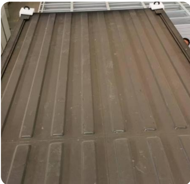
Verschweißtes Stahldach beim Hersteller
