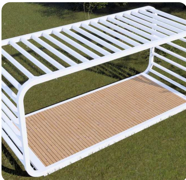
Das Tragwerk mit Deck, ohne Hülle
